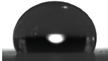
Βαμμένη επιφάνεια με SurfaPaint Aqua X Γωνία επαφής: 126°
