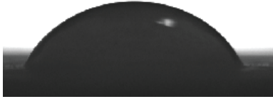
Βαμμένη επιφάνεια με απλό χρώμα Γωνία επαφής: 60°
