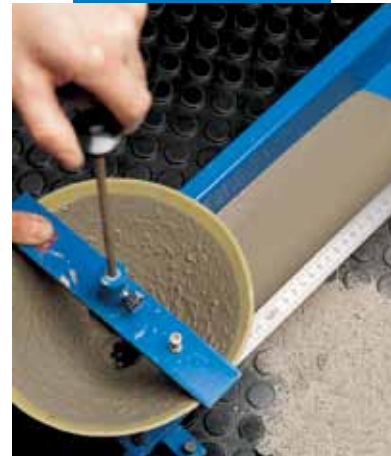
Δοκιμή ρευστότητας σύμφωνα με το πρότυπο UNI 13395-2
